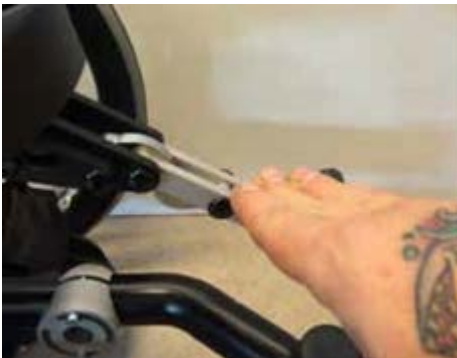
Abb. 07 Feststellbremse Aktivieren (nach unten drücken)
