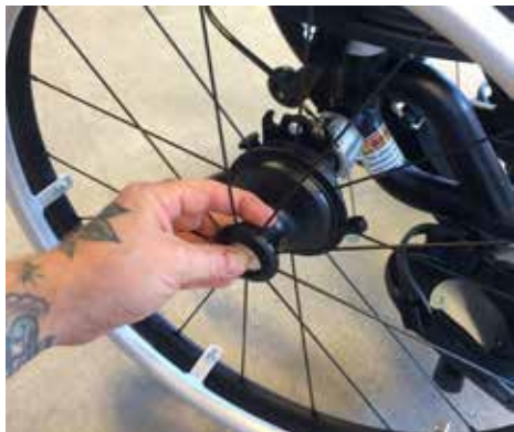
Abb. 11 Antriebsräder abnehmen und Rücken umklappen
