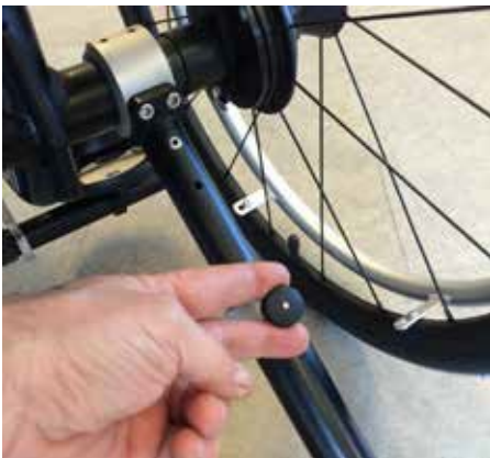
Abb. 09c Maximal ausgefahren 7 Grad Kippung
