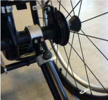
Abb. 09a Eingeschobene Position – deaktiviert
