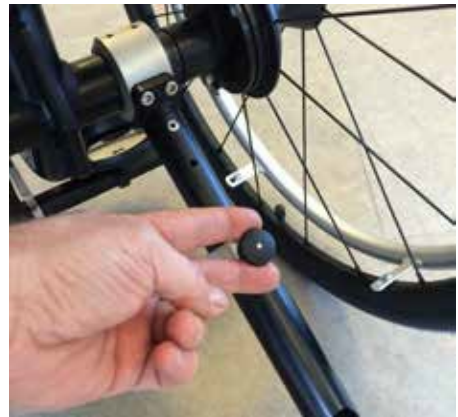
Abb. 09d Kippwinkel 14 Grad bei Einrasten in der vorletzten Position.
