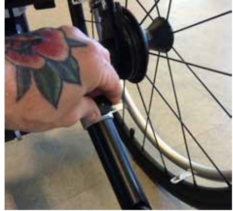
Abb. 09b Splint ziehen und Kippsicherung ausschieben
